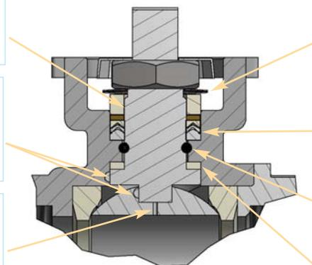
Tellerfedern gewährleisten die dauerhafte Vorspannung des Dachmanschettenatzes.
