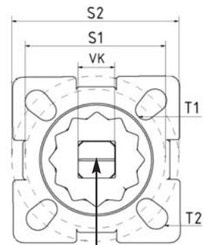
Schliff gibt Stellung der Kugelbohrung an
