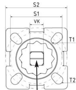
Schliff gibt Stellung der Kugelbohrung an
