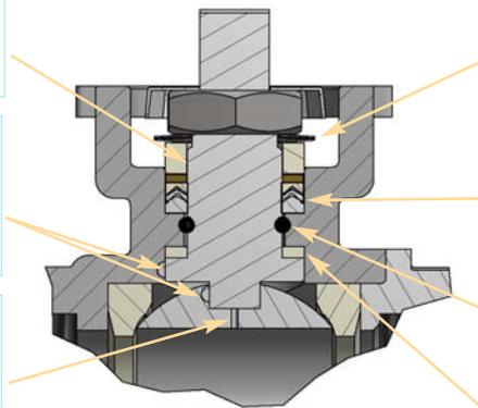
Tellerfedern gewährleisten die dauerhafte Vorspannung des Dachmanschettensatzes.
