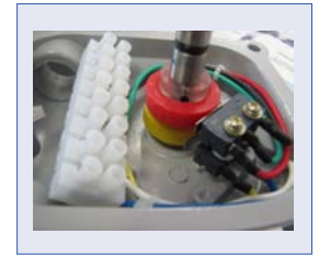
Wechselschalter N.O. / N.C. SPDT Fabr. Honeywell, Typ ZM50D
