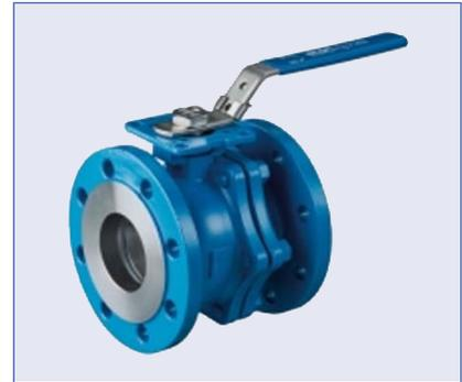
**2-Wege Flansch-Kugelhahn** für den industriellen Einsatz konzipiert. Hochwertige Verarbeitung und vielfältige Qualifikationen ermöglichen einen großen Verwendungsbereich. Ausführung als 2-teiliges, geflanshtes Gehäuse, Druckbereich Nennweitenabhängig bis 40,0 bar. Kugel mit vollem Durchgang, schwimmend gelagert, beidseitig 100% dichtschießend. Wellenabdichtung bestehend aus mehrlagigen Graphit Ringen, vorgespannt und selbst nachstellend mittels Tellerfedern und zusätzlichem FKM O-Ring.
