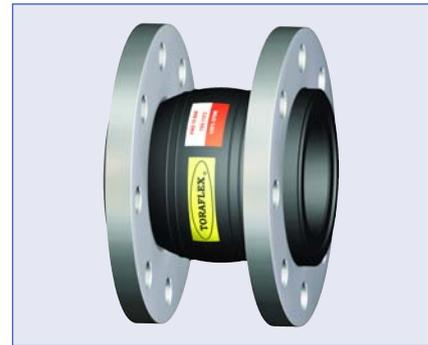
Mehrlagiger Gummikomparator zum Ausgleich von Bewegungen (axial, lateral und angular) in Rohrleitungen, insbesondere bei thermischen Längenänderungen und Vibrationen. Beidseitig lose, drehbare verzinkte Flansche, wahlweise mit Anschluss gemäß Druckstufe PN 10 oder PN 16.
