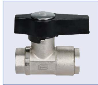
Messing Hochdruck-Kugelhahn einsetzbar **bis 210 bar**. Besonders geeignet für den industriellen Einsatz in ölhydraulische und pneumatische Anwendungsbereiche. Schwerer Messingkörper, Kugel mit reduzierter Durchgangsbohrung, Schaltspindel mit 3-fach Dichtsystem (2 konisch selbstnachstellende PTFE Halbringe und zusätzlich ein FKM O-Ring).
