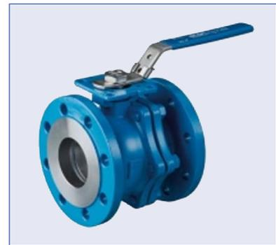
**2-Wege Flansch-Kugelhahn** für den industriellen Einsatz konzipiert. Hochwertige Verarbeitung und vielfältige Qualifikationen ermöglichen einen großen Verwendungsbereich. Ausführung als 2-teiliges, geflanshtes Gehäuse, Druckbereich bis 16,0 bar. Kugel mit vollem Durchgang, schwimmend gelagert, beidseitig 100% dichtschießend. Wellenabdichtung bestehend aus mehrlagigen Graphit Ringen, vorgespannt und selbst nachstellend mittels Tellerfedern und zusätzlichem FKM O-Ring.
