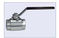
Beim Schweißen der Stutzen SW und BW ist das Gehäuse des Kugelhahns entsprechend abzukühlen, damit die Dichtungen nicht beschädigt werden. Das Gehäuse darf NIEMALS den Wert von 120° C überschreiten.
