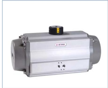
Die neueste Generation pneumatischer Stellantriebe bietet neben dem hohen Qualitätsstandard auch innovative Lösungen wie zum Beispiel die leichte äußere Drehwinkel-einstellung von 75° bis 95°, einfachwirkende Antriebe mit gefesselten Federn mit gleichen Abmessungen.
